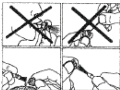
6. Ábra. A porlasztó tisztítása
